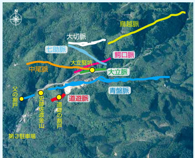
図5 相川金銀山の主金銀鉱脈の分布 地理院地図(電子国土web)写真を加工
